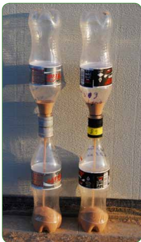
איור 2: המערכת הניסוינית הכוללת שני בקבוקי שתייה בנפח של חצי ליטר המחוברים זה לזה באמצעות שני פקקים שבהם חור. החול זורם מן הבקבוק העליון לבקבוק התחתון.
